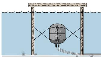
Die einfache Montage erfolgt durch Ausgleichgewichte auf dem Gewässergrund oder alternativ durch Verankerungen an Pfahlkonstruktionen, Bootsstegen oder am Kai (siehe Grafik). Die Anbindeleitungen aus PE werden mittels Heizwendelschweißung sicher angeschlossen.
